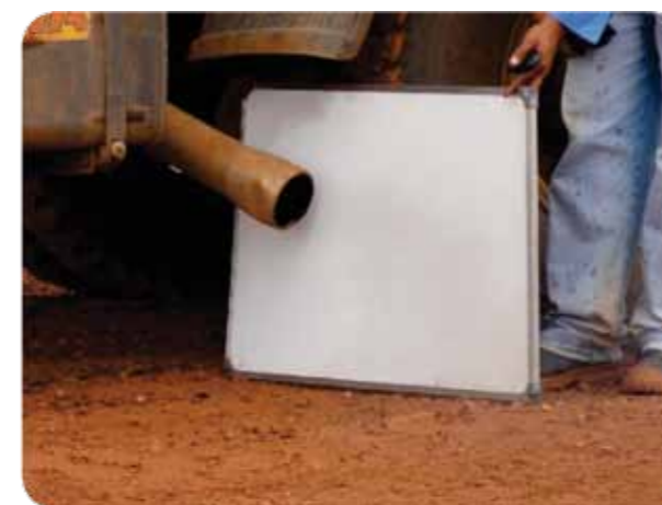
Figura 12 – Medição da emissão de fumaça e fuligem pelo índice da escala Rigelmann. BR-319/RO – Ponte sobre o Rio Madeira.
